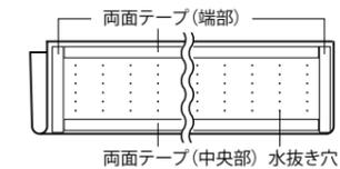
両面テープは剥離紙を指でしっかり押し付け、縫い目間のバックング溝にも隙間のないよう貼ってください。
