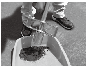
円筒刃内部に入った土はレバーを踏んで押し出します。
