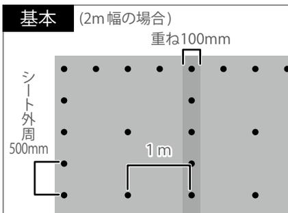
シート外周・ジョイント部は500mm、内側は1mピッチでピンを打ちます。
