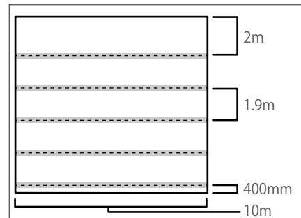
100m<sup>2</sup>正方形施工の場合、グレーのラインが接続テープ貼り付け箇所となります。
