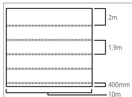
100m<sup>2</sup>正方形施工の場合、グレーのラインが接続テープ貼り付け箇所となります。
