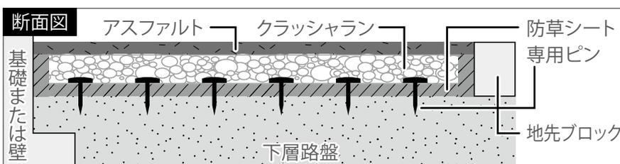
防草シートを曝露時と同じように敷き、スミ付け箇所に専用ピンを1mピッチで打ち、シートを固定します(1~2本/㎡)。
