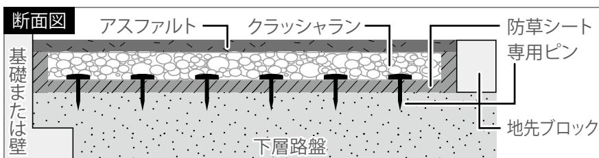
防草シートを曝露時と同じように敷き、スミ付け箇所に専用ピンを1mピッチで打ち、シートを固定します(1~2本/m<sup>2</sup>)。
