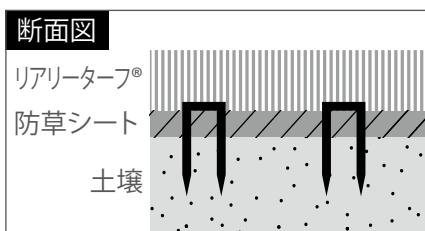
防草シートを曝露時と同じように敷き、スミ付け箇所に専用ピンを1mピッチで打ち、シートを固定します。(1~2本/m<sup>2</sup>)
