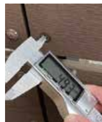
下孔( \Phi 7\text{mm} )があいていない
